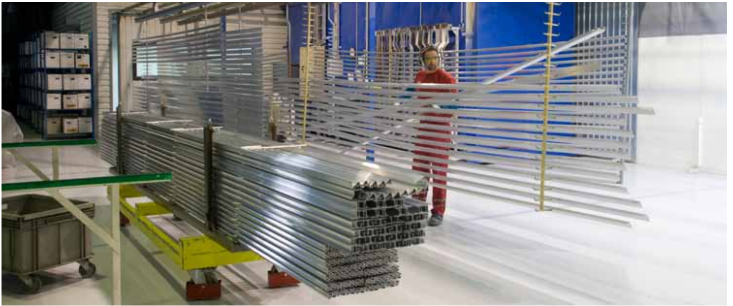
Salko har en pulverlackeringslinje specialanpassad även för långlängdsprofiler. Förbehandling sker med miljövänliga, kromfria processer.
