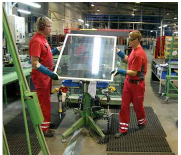
Specialanpassad monteringslinje med bl a slutmontering av fönsterramar inkl glasning.
