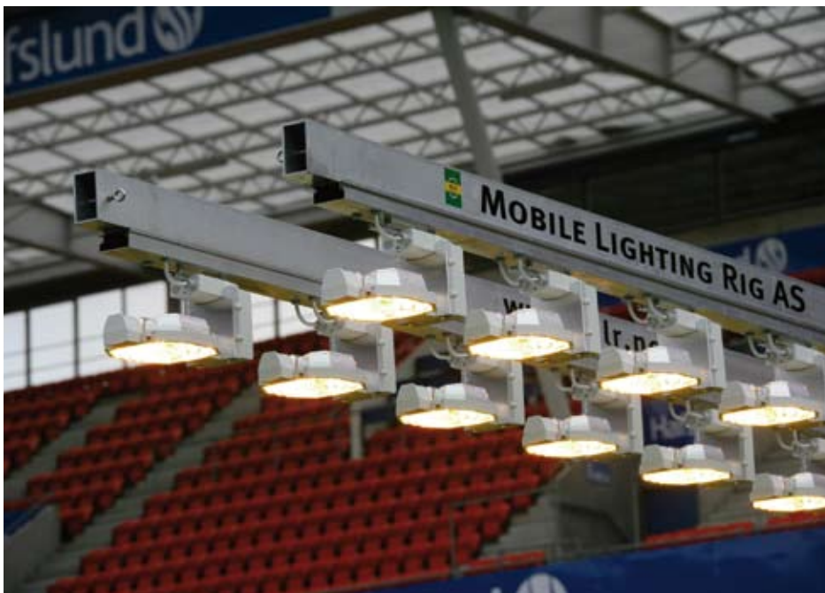
MLR:s ljustripp på Gamla Ullevi i Göteborg består av tre moduler med artificiell ”sol” i form av 294 tusenwattslampor!
