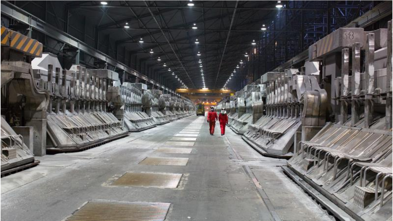
Bilde 1: Elektrolysehall ved Årdal Metallverk
