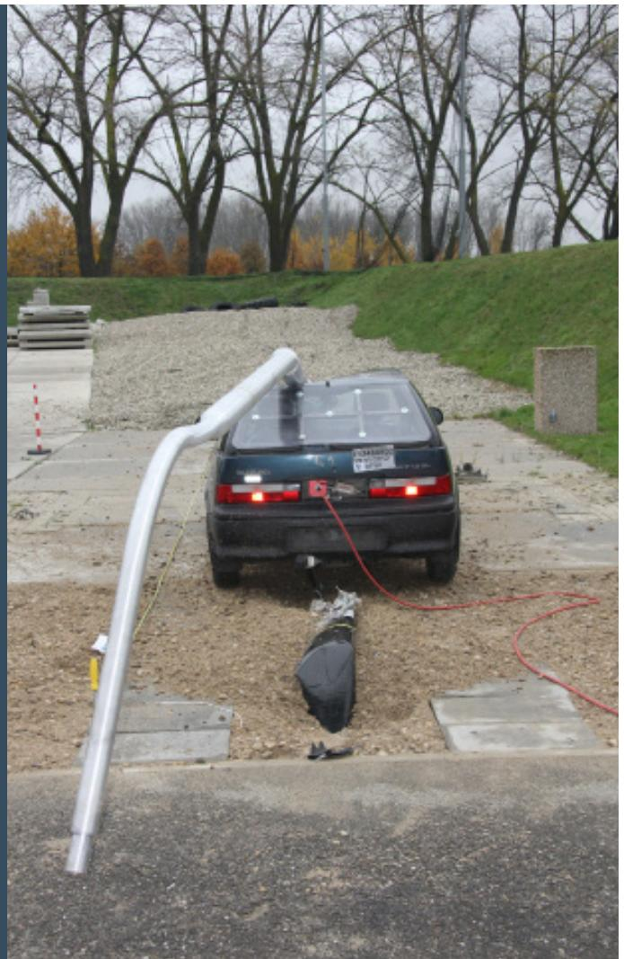
Aufprallfreundliche Lichtmasten in der Kategorie HE (high energy absorbing). Hierbei wird die Geschwindigkeit des Fahrzeugs beim Aufprall deutlich und abrupt reduziert. Das Risiko einer sekundären Kollision mit Bäumen, Fußgängern und anderen Verkehrsteilnehmern wird reduziert.
