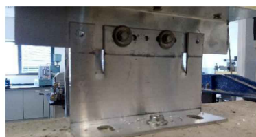
Resistencia a tracción ménsula 150 x 100 (tornillos posición interior)
