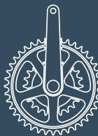
**Cranques:** o alumínio proporciona um bom equilíbrio entre resistência e leveza e, para esta aplicação, os fabricantes de bicicletas apreciam a trabalhabilidade e soldabilidade do metal.
