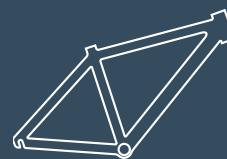
**Quadro:** o alumínio proporciona à estrutura principal da bicicleta um excelente equilíbrio de força, peso e resistência à corrosão. Também é adequado para soldar e moldar as geometrias complexas dos quadros de bicicleta modernos.
