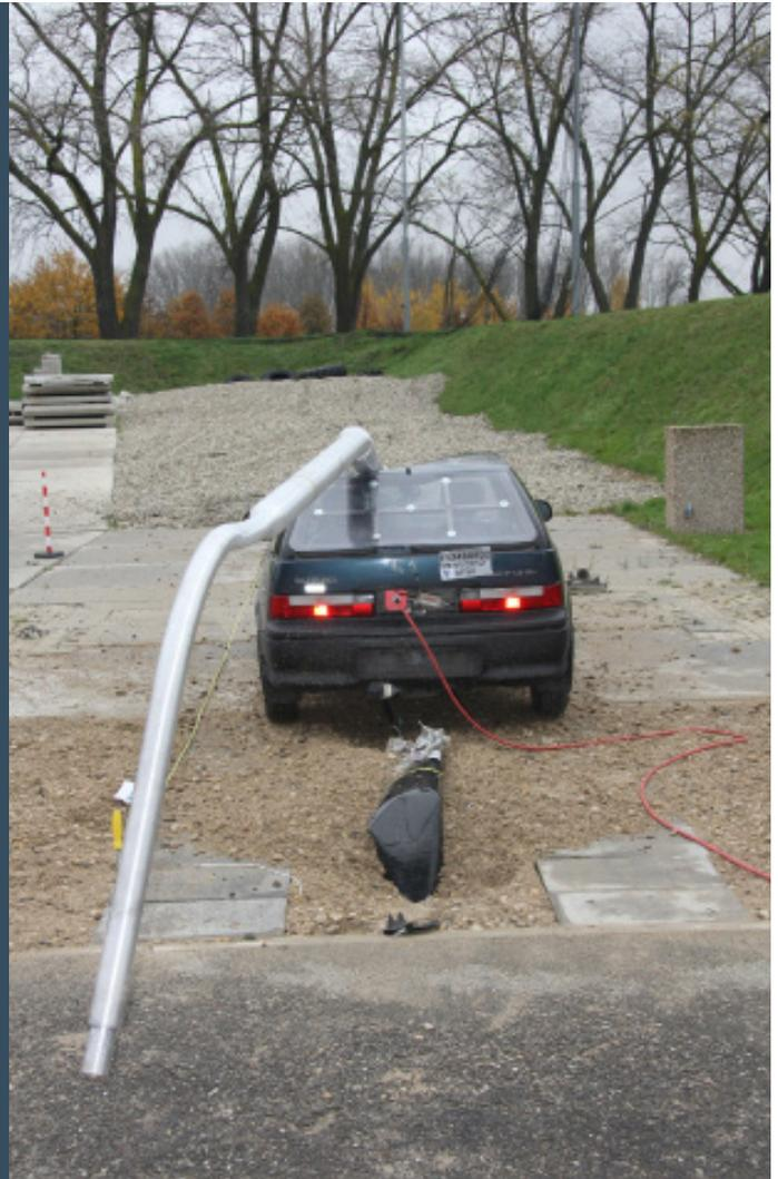
I pali ad alto assorbimento di energia (HE) rallentano notevolmente la velocità del veicolo in caso di impatto. Il rischio di impatti secondari, per esempio con alberi, pedoni e altri veicoli viene diminuito.
