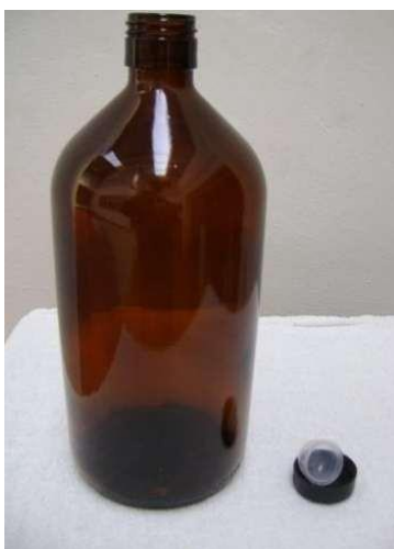
Figura 22 – Modelo de frasco de borosilicato, cor âmbar, com capacidade de 1L para amostragem de óleo (análise de PAH/Benzeno)
