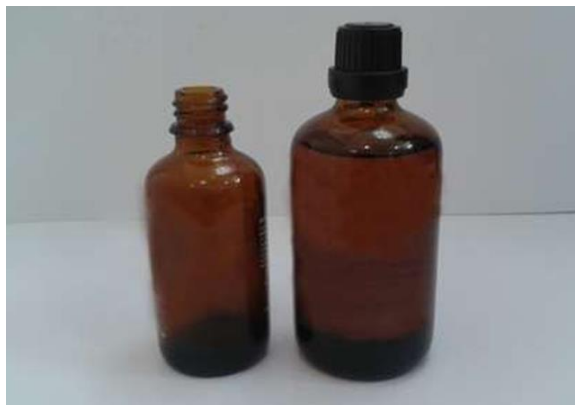
Figura 21 – Modelo de frasco de borosilicato com capacidade de 100mL e tampa rosqueável, para amostragem de óleo (análise de BETEX)
