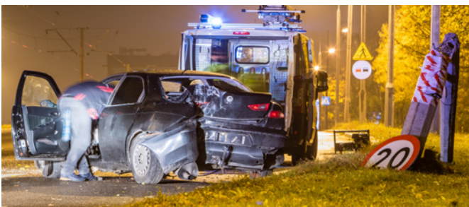
Gevaarlijk ongeval door een niet-botsveilige mast
